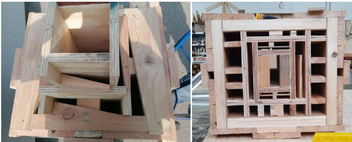
Abbildung A5: „Fledermausrakete“ – mit gut 30 Spaltenquartieren von unten – links verkleidet und rechts (© Bio Celan GmbH) im Bau.
