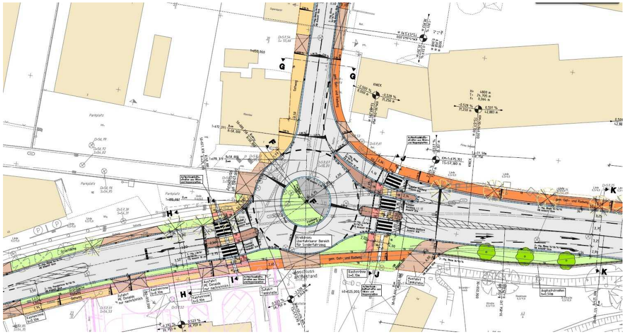
Abb. 2 Gestaltungsvorschlag für einen Kreisverkehr mit Bypass
