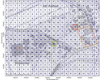
Abbildung 1: Gesamtbelastung (Jahreshäufigkeiten Geruchsstunden) auf 20 m \* 20 m großen Beurteilungsflächen
